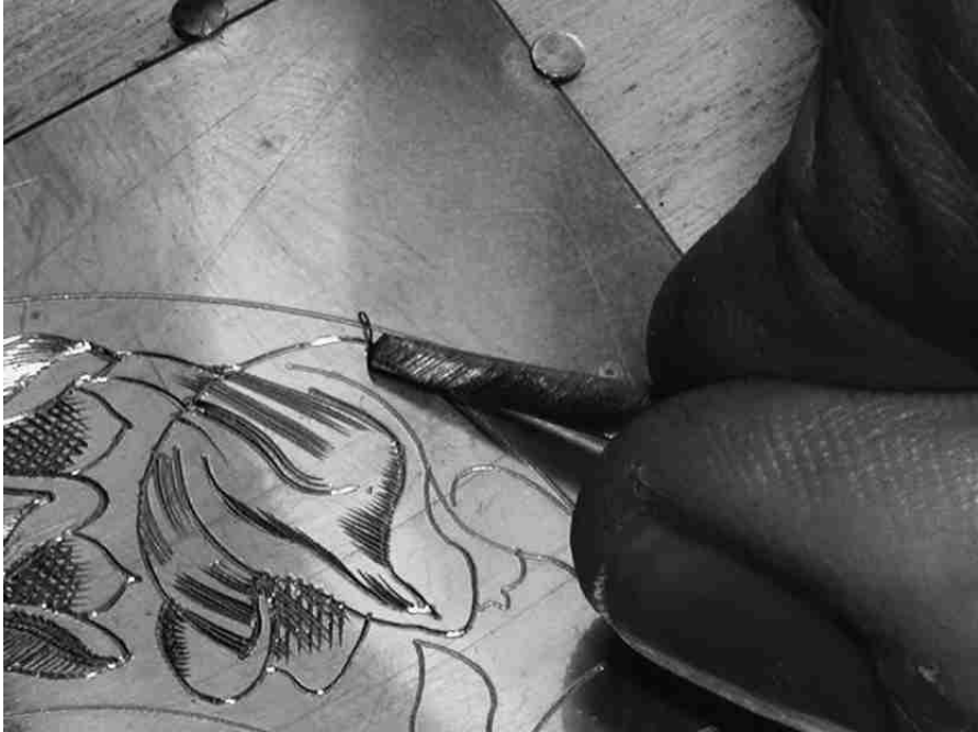
Figuur 1: het graveren door middel van een burijn. Foto: Lei Lennaerts
